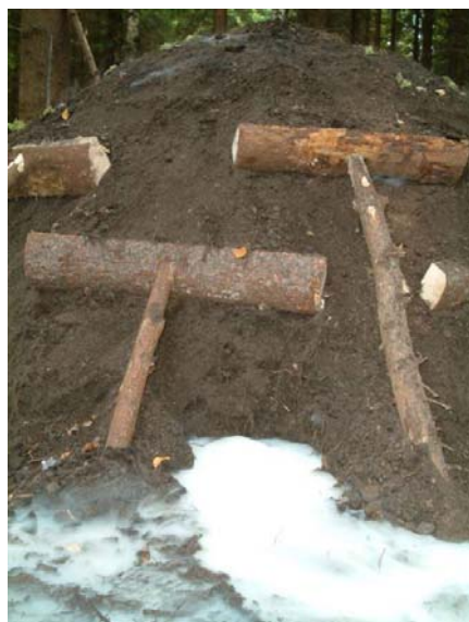
Rök från fotrymning efter tätning av toppen.
