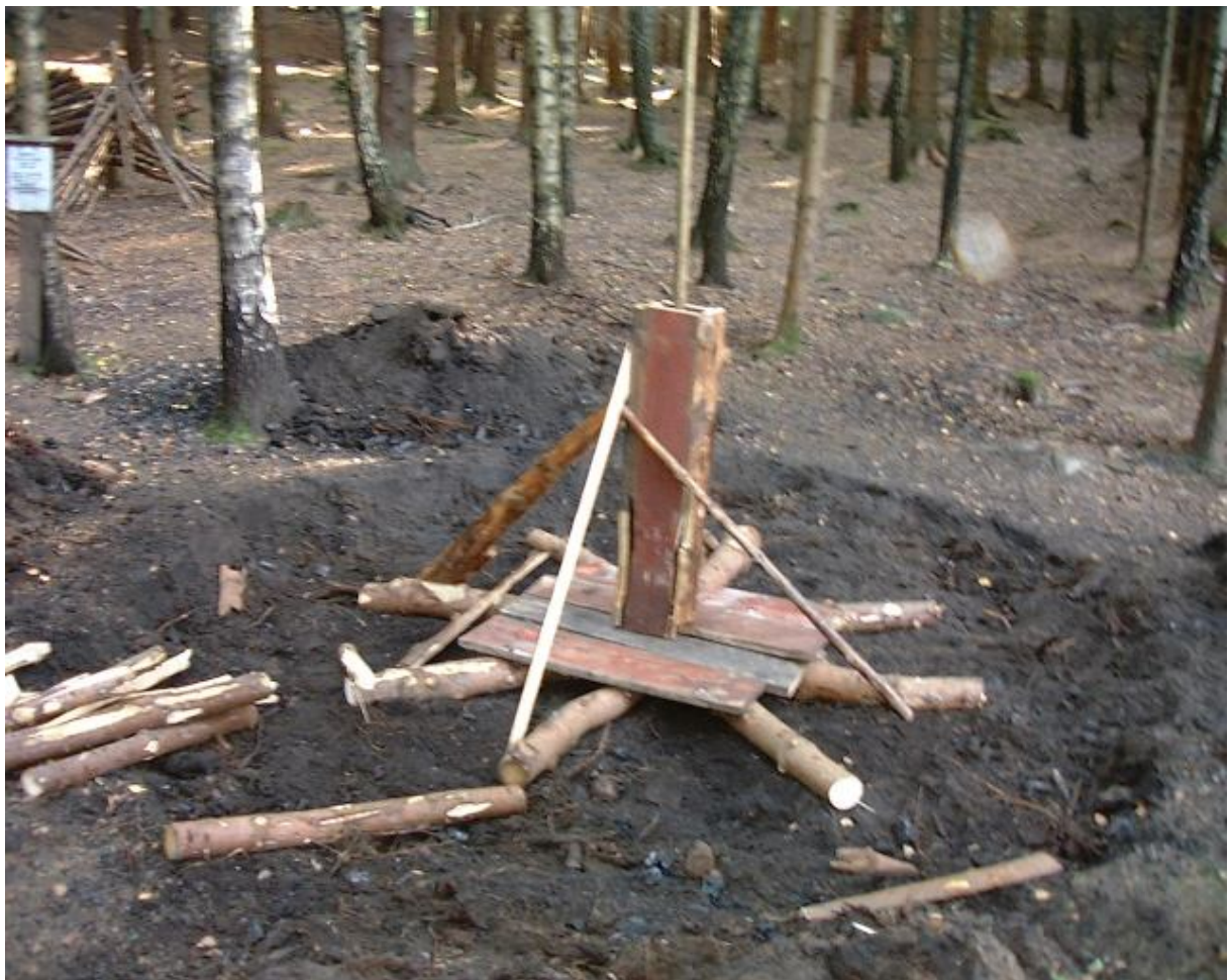
Milbotten är rensad, "ekrarna" är utlagda, kungen är rest och rätstaken rest. Även golvbygget är påbörjat.
