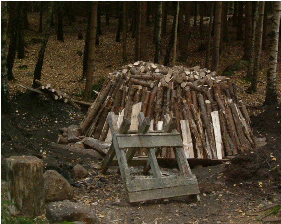
Milans ved är färdigstaplad på ett golv av bakar med luftkanal under. Det är viktigt att veden är tätt staplad och att milan har fått en konisk form.
